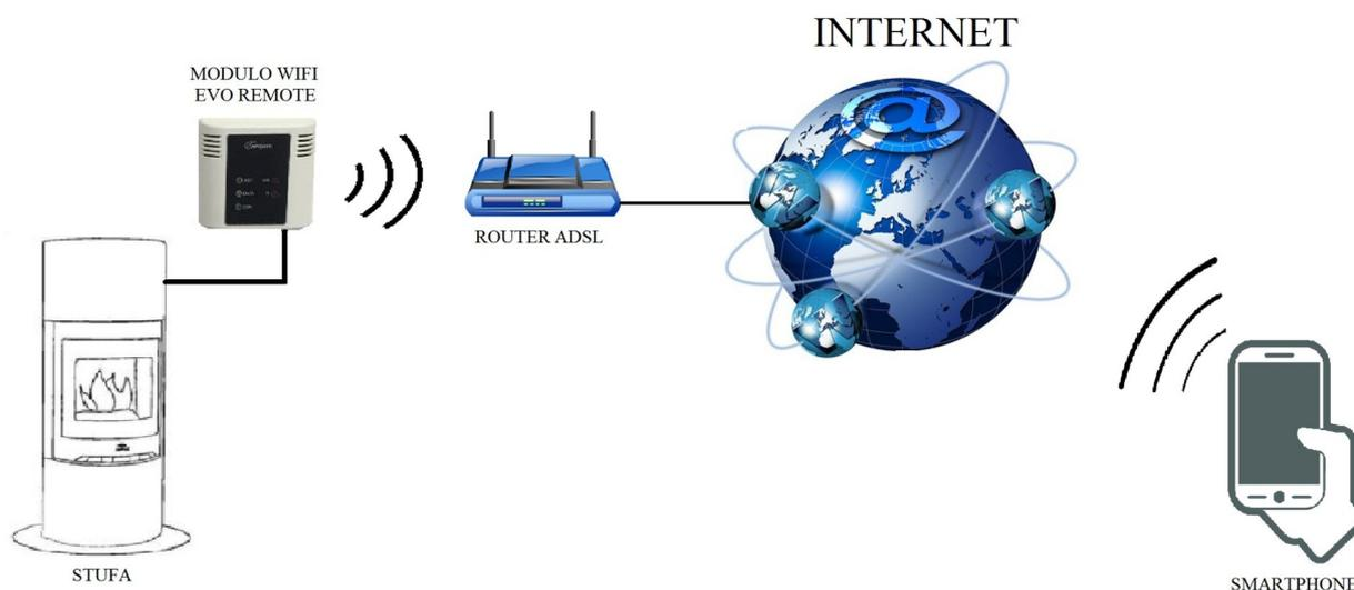
Nella modalità Remota, il modulo WiFi M1 è collegato via cavo alla stufa, e attraverso una connessione Wireless viene connesso ad un router. Il router connette il modulo WiFi ad internet.
